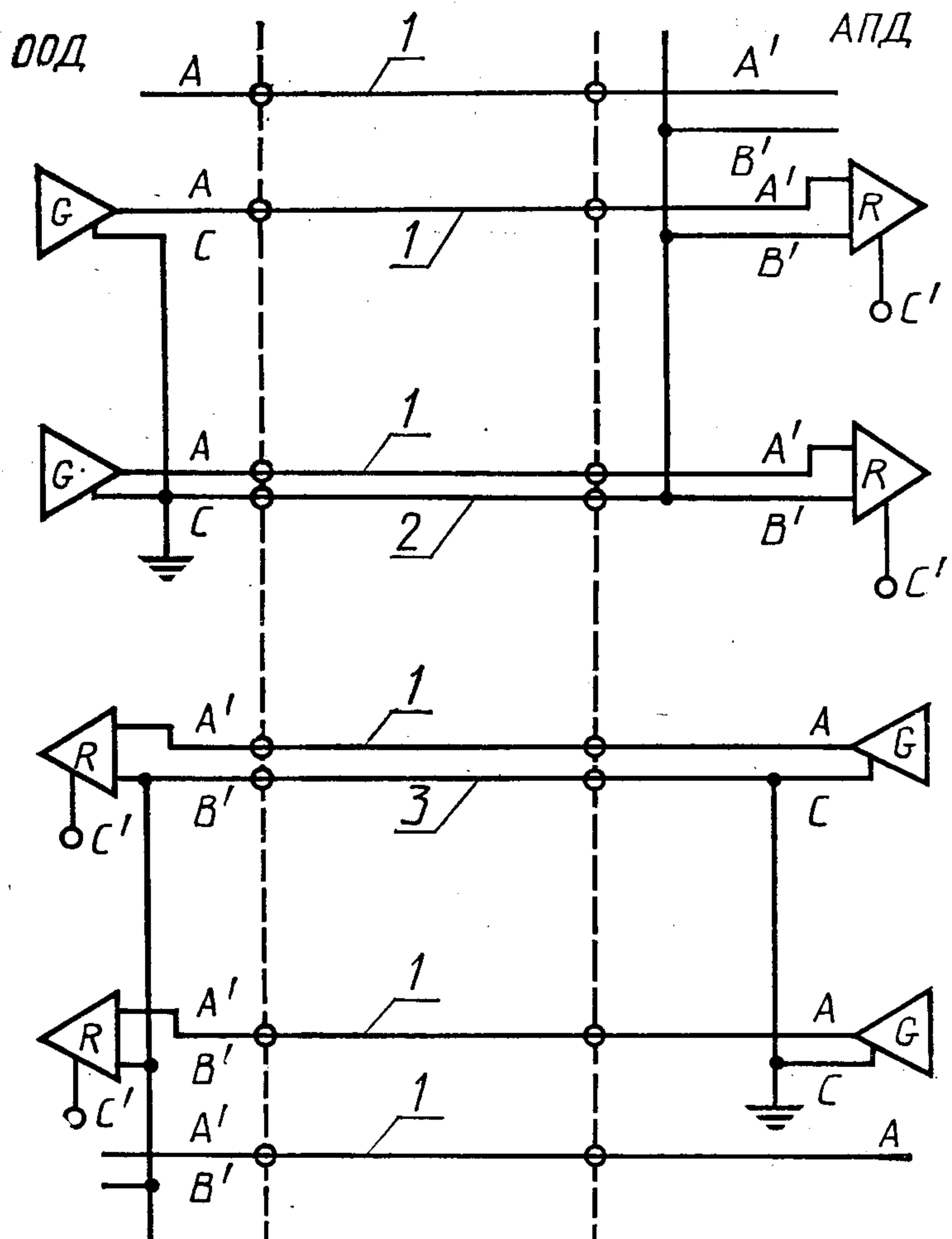
1—сигнальный провод; 2—обратный провод ООД (цепь 102 а); 3—обратный провод АПД (цепь 102 б)
