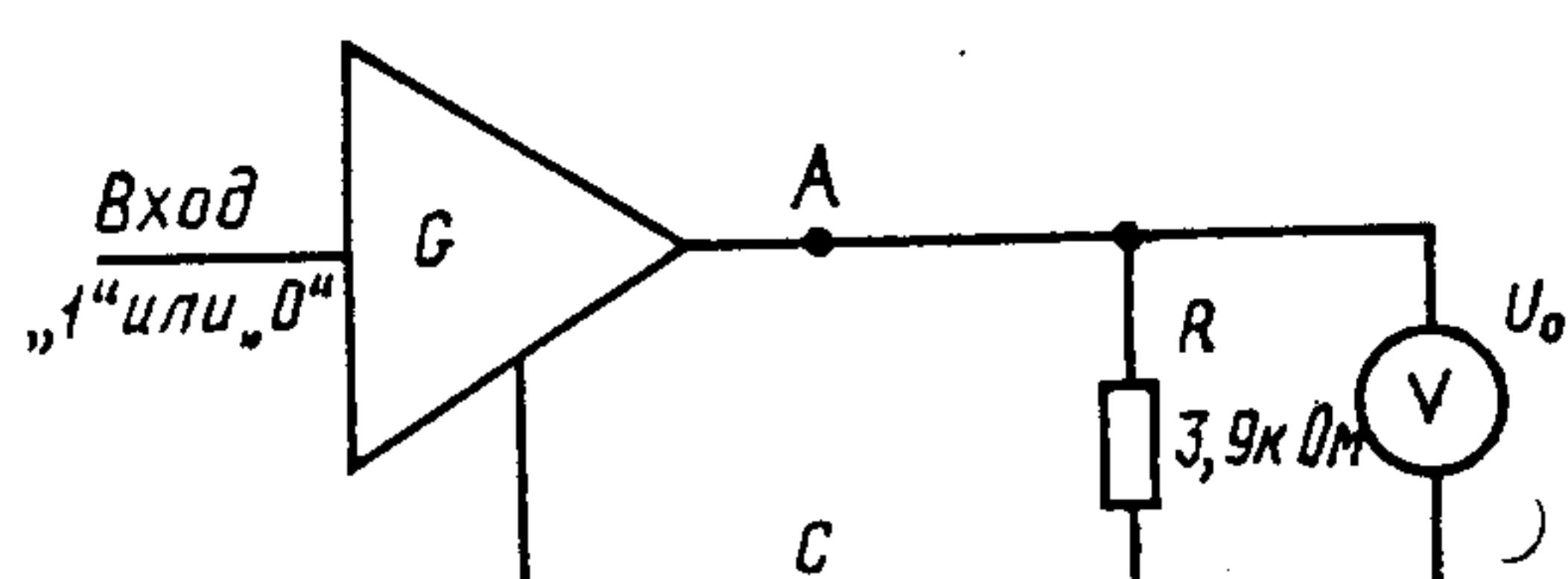
$U_0$ —выходное напряжение генератора
