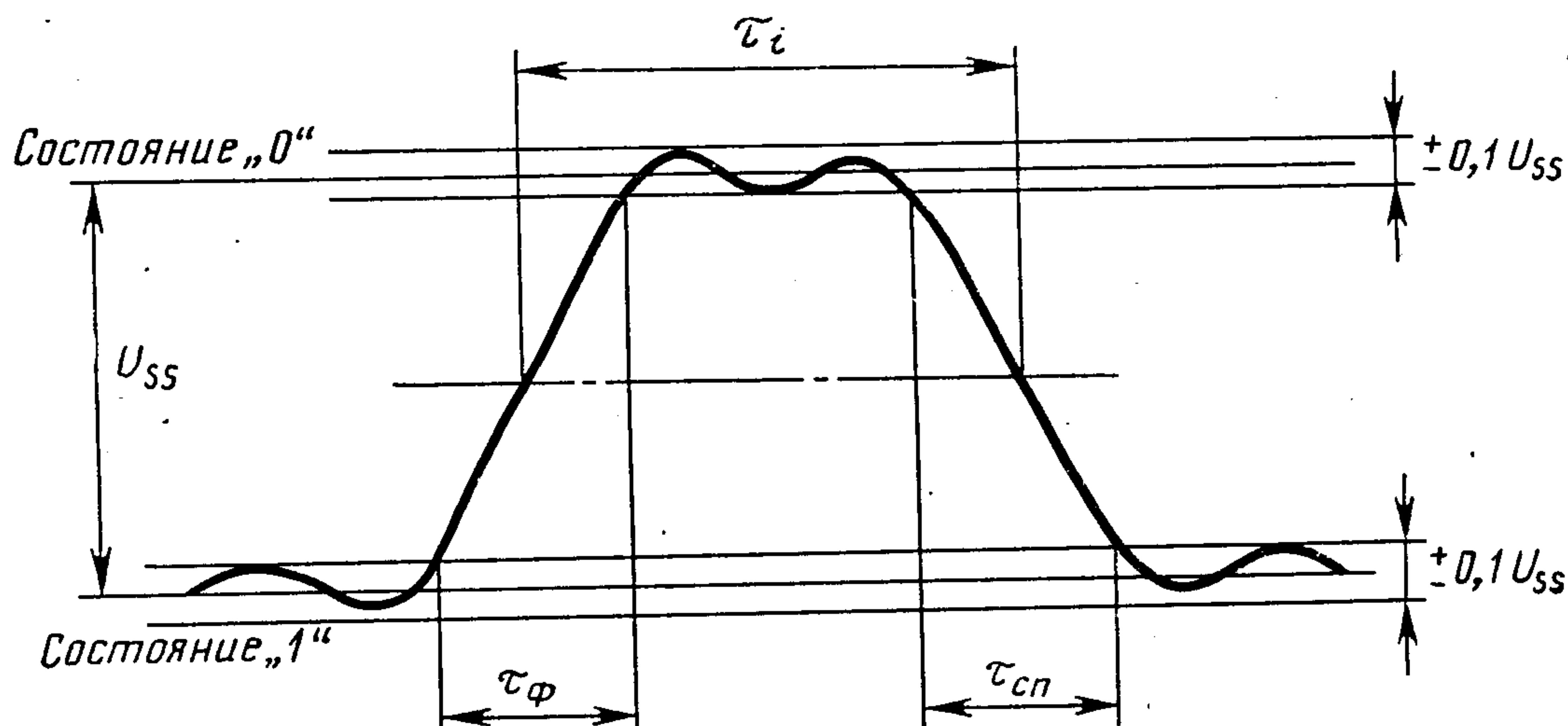
$\tau_i$  — номинальная длительность единичного элемента испытательного сигнала;  $\tau_\phi$ ,  $\tau_{сп}$  — длительность фронта и спада сигнала
