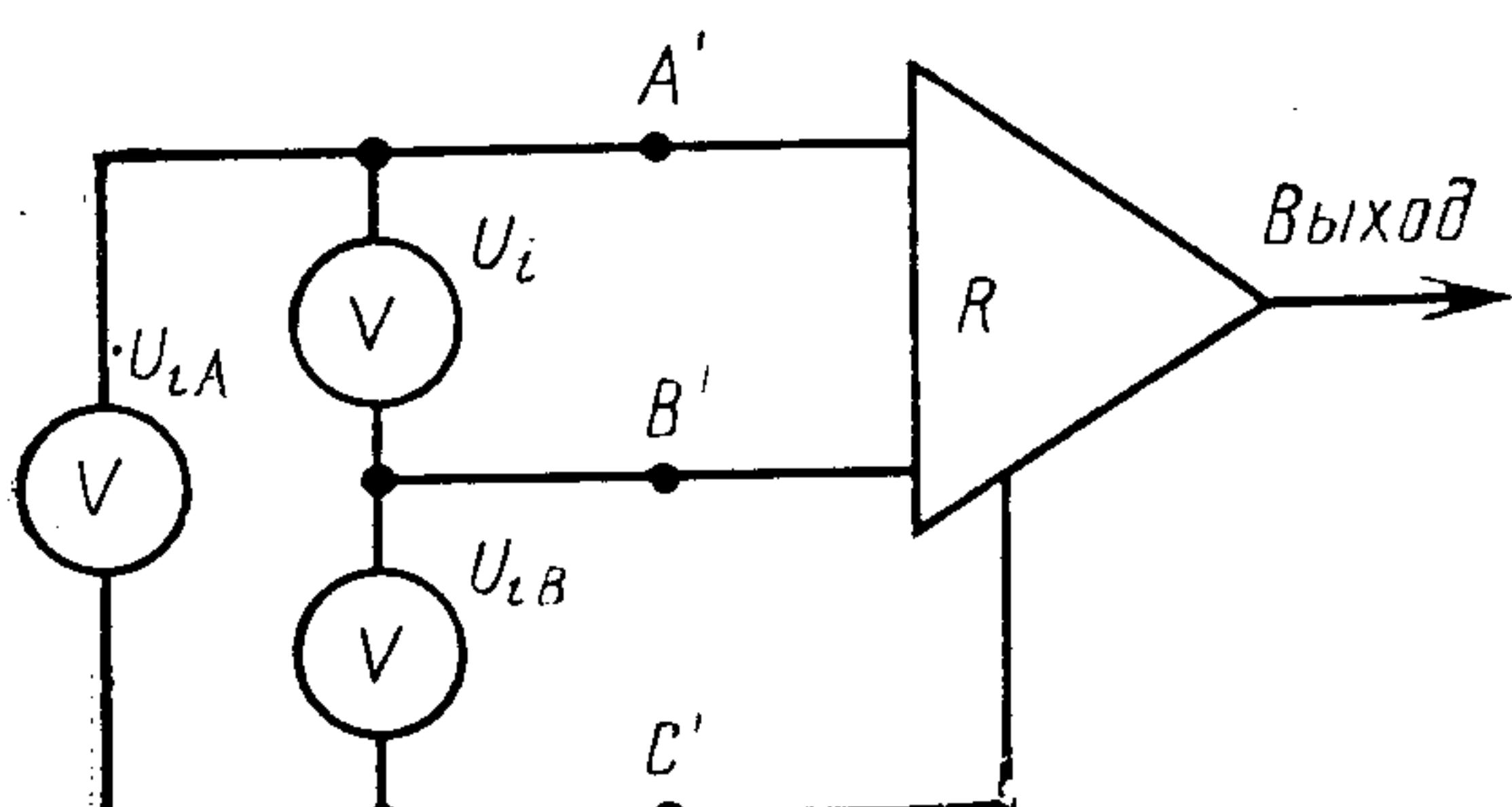
$U_i$  — входное напряжение приемника;  $U_{iA}$  — входное напряжение приемника между точками  $A$  и  $C$ ;  $U_{iB}$  — входное напряжение приемника между точками  $B$  и  $C$
