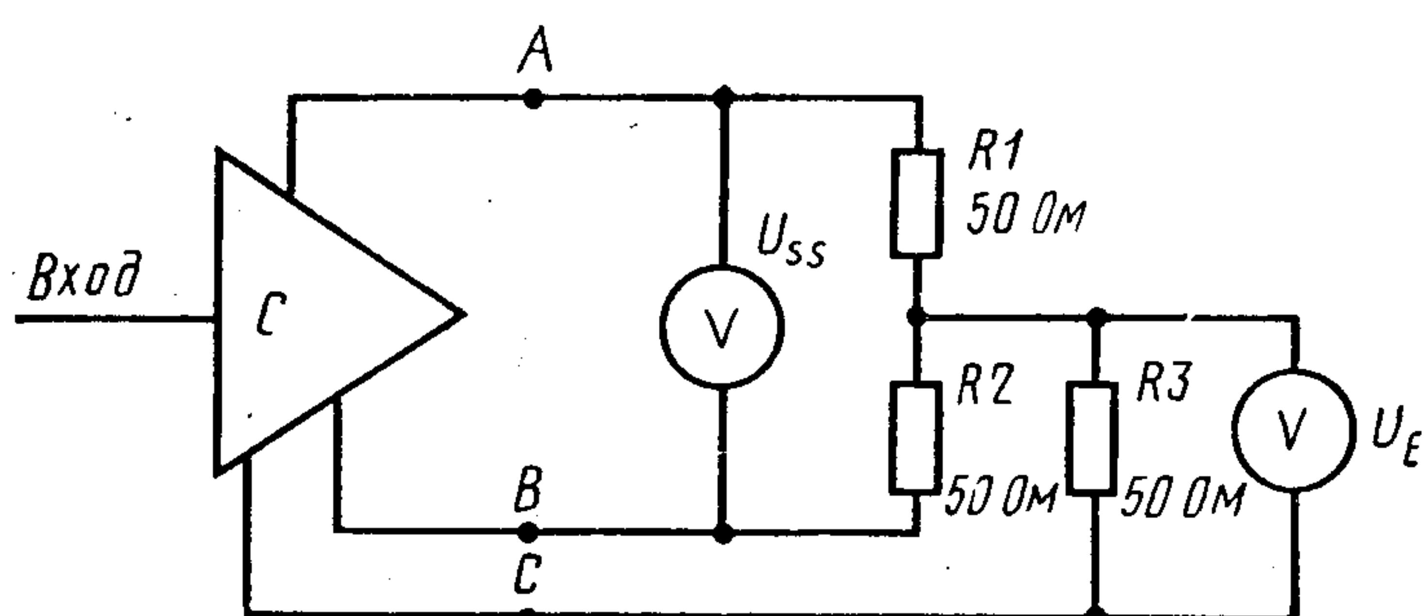
$U_E$  — напряжение разбаланса генератора;
