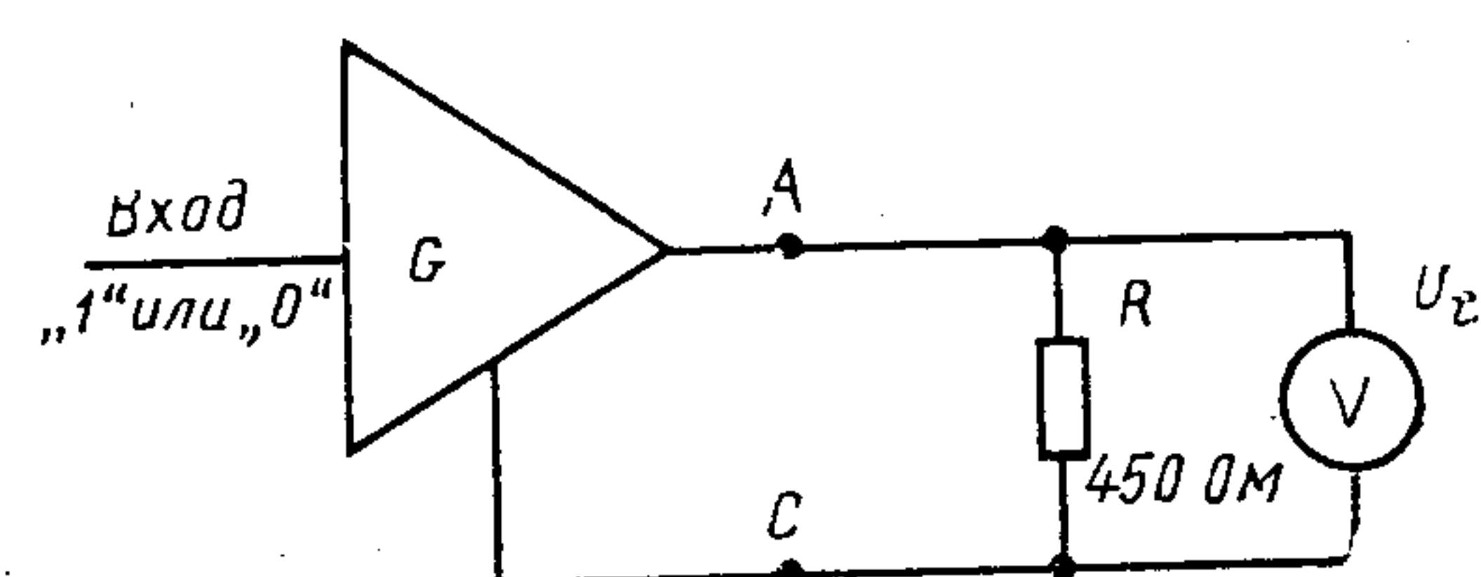
$U_t$ —выходное напряжение генератора на нагрузке 450 Ом
