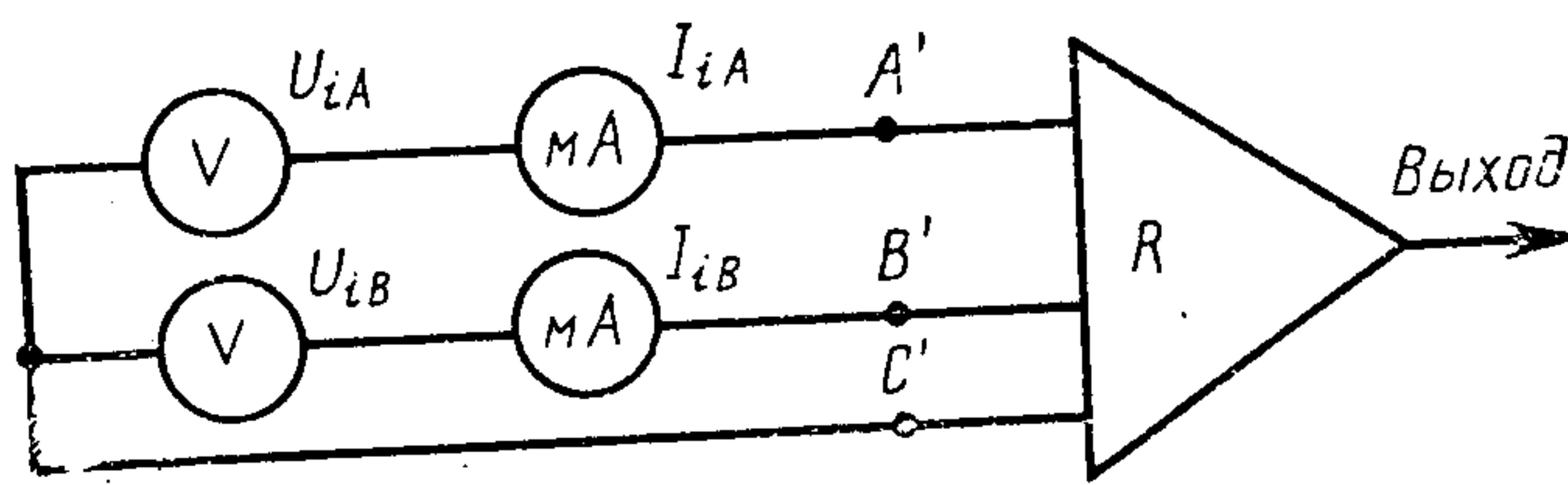
$U_{iA}$  — входное напряжение приемника между точками  $A$  и  $C$ ;  $U_{iB}$  — входное напряжение приемника между точками  $B$  и  $C$ ;  $I_{iA}$  — входной ток приемника через точку  $A$ ;  $I_{iB}$  — входной ток приемника через точку  $B$
