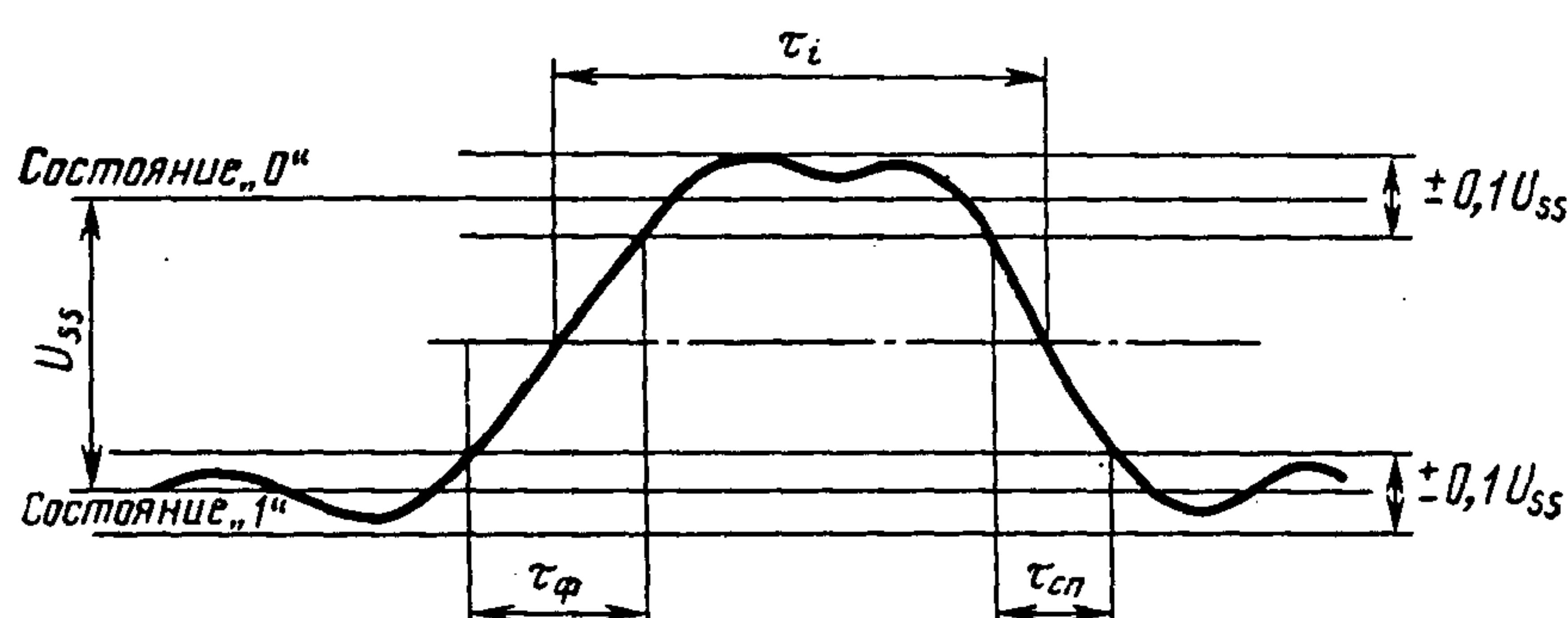
$\tau_i$  — номинальная длительность единичного элемента испытательного сигнала;  $\tau_\phi$ ,  $\tau_{sp}$  — длительность фронта и спада сигнала
