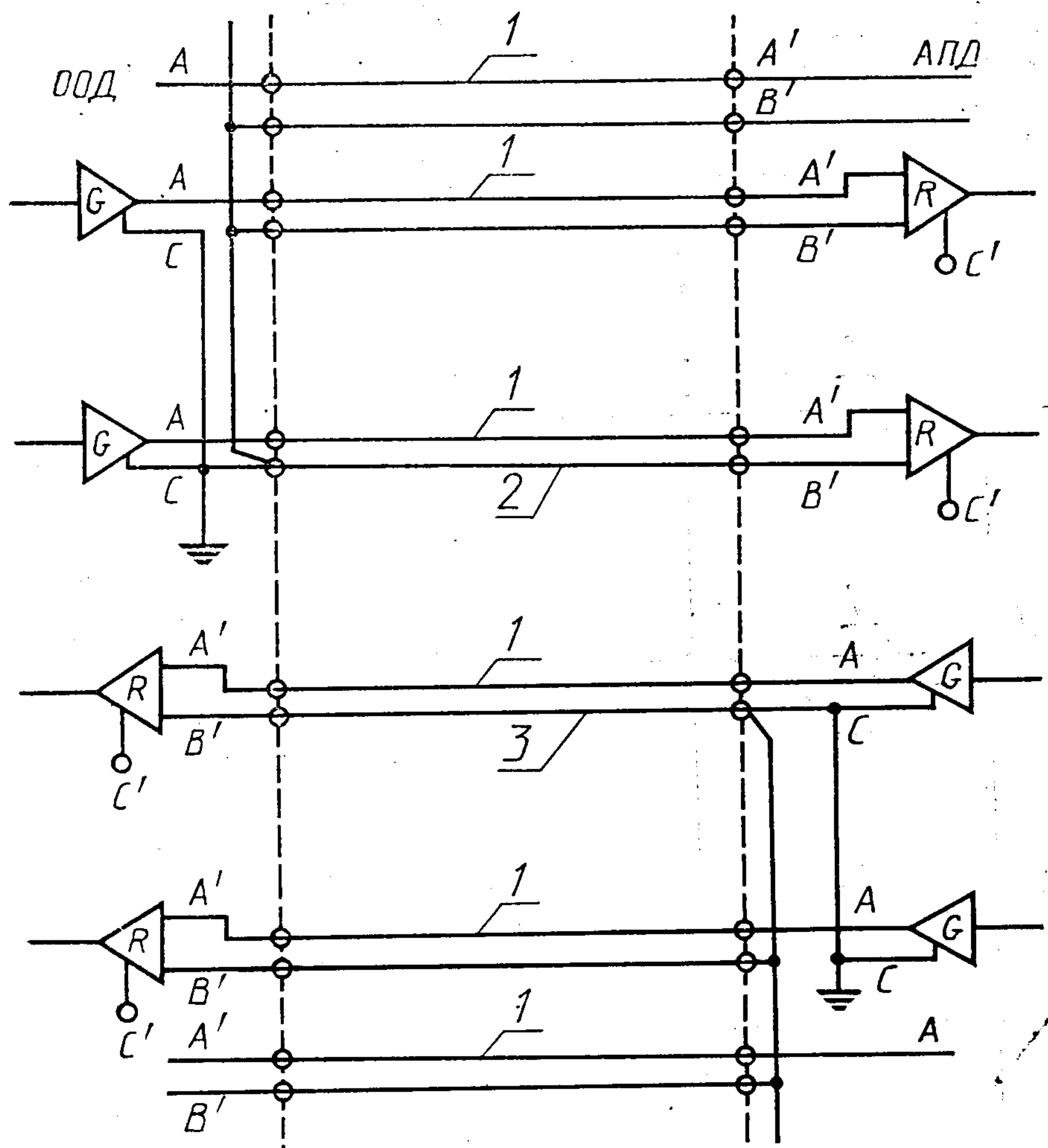
1—сигнальный провод; 2—обратный провод ООД (цепь 102 а); 3—обратный провод АПД (цепь 102 б); А—активная точка стыка генератора; С—точка сигнального заземления генератора; А'—активная точка стыка нагрузки; В'—точка сигнального заземления нагрузки; С'—нулевая точка приемника
