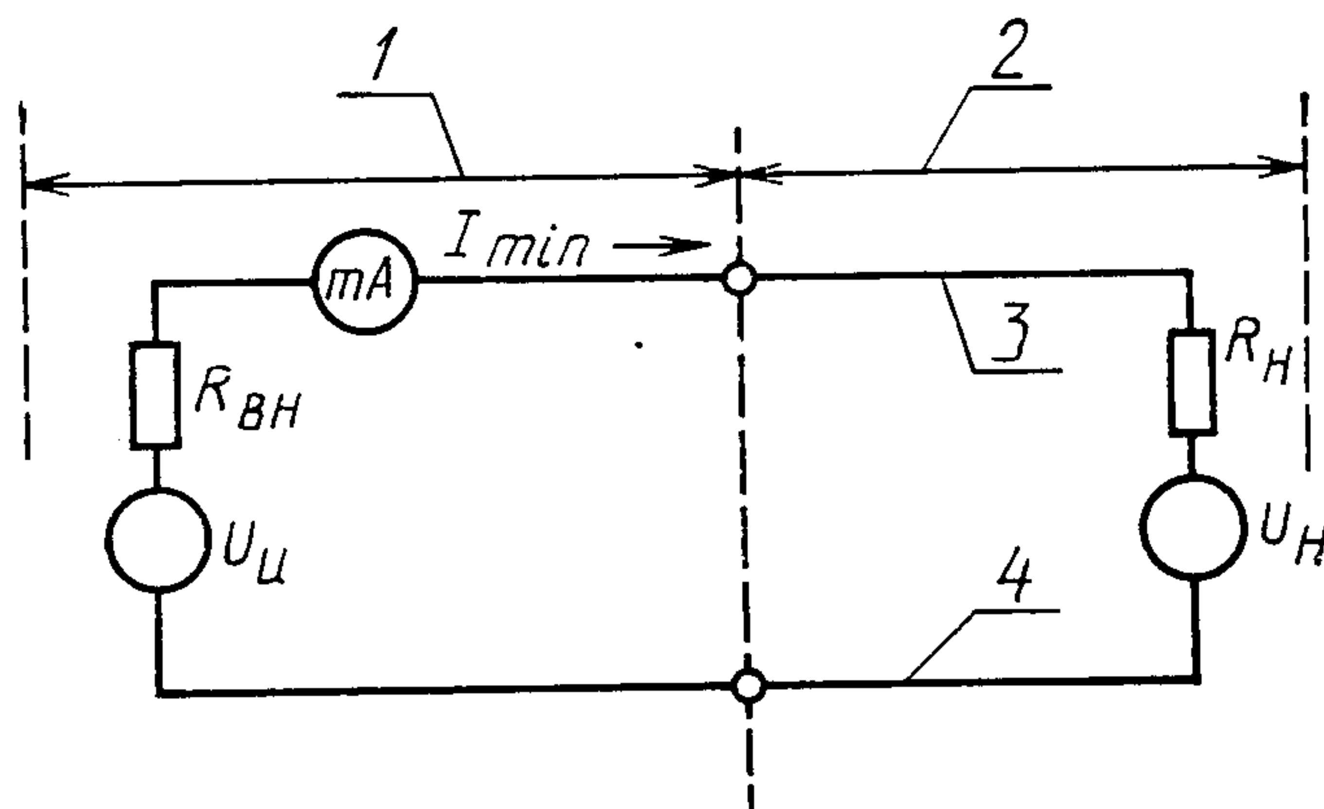
1—измерительный прибор; 2—нагрузка; 3—цепь стыка; 4—сигнальное заземление;  $U_H$ —напряжение, используемое для измерения сопротивления нагрузки;  $I_{min}$ —минимальное значение измеряемого тока;  $I_{max}$ —максимальное значение измеряемого тока;  $R_{BH}$ —внутреннее сопротивление измерительного прибора;  $U_H$ —напряжение на нагрузке при отключенной цепи;  $R_H$ —сопротивление нагрузки
