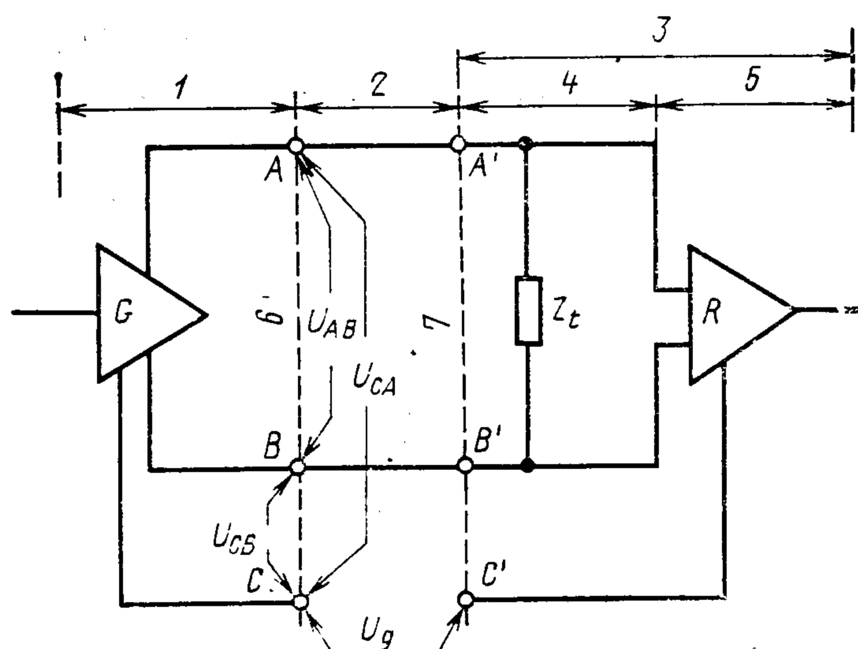
1—генератор; 2—симметричный соединительный кабель;
