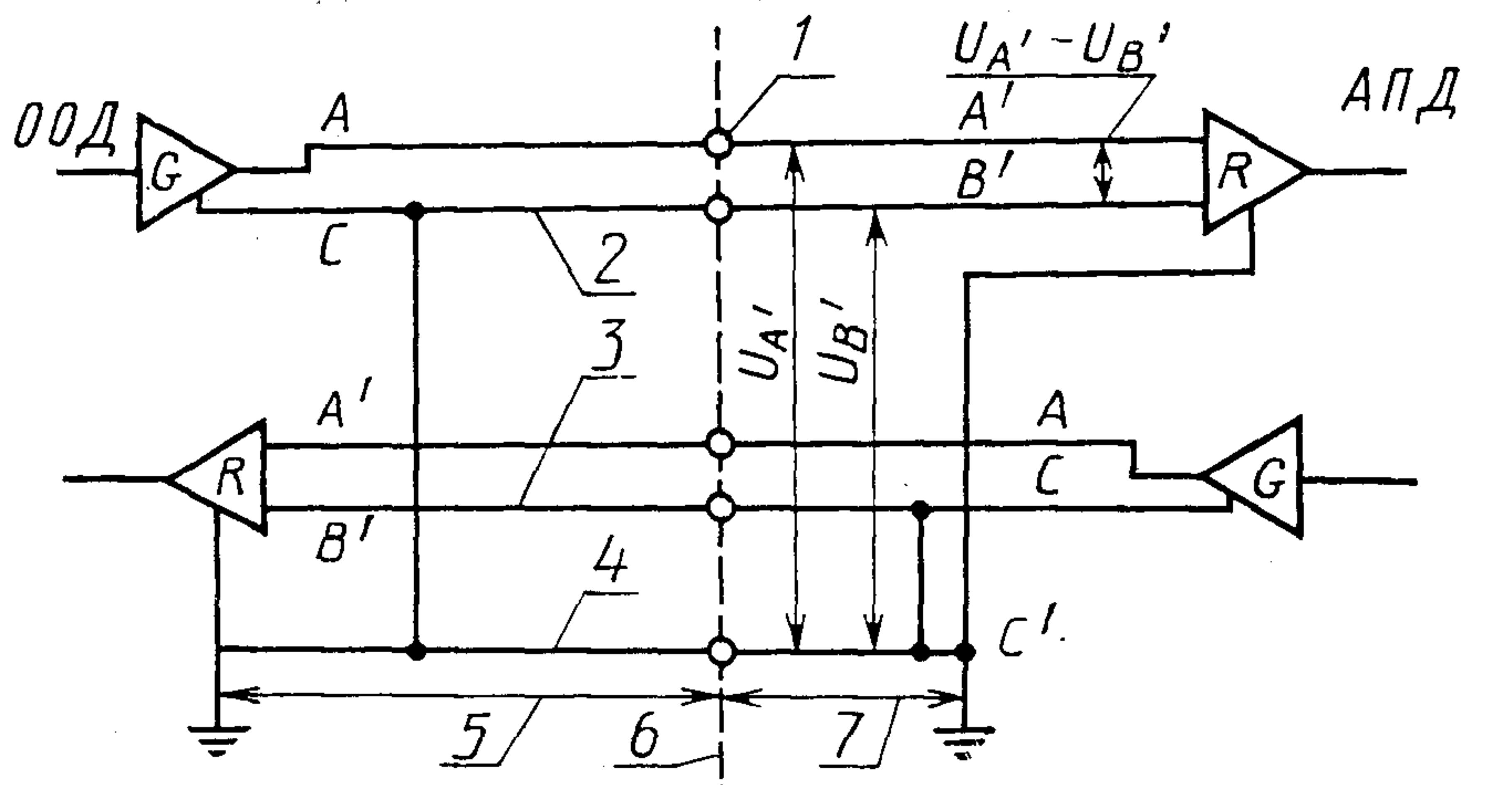
1—разъем; 2—обратный провод ООД (цепь 102 а); 3—обратный провод АПД (цепь 102 б); 4—сигнальное заземление (цепь 102); 5—ООД и соединительный кабель; 6—линия разграничения; 7—АПД; А—активная точкастыка генератора; С—точка сигнального заземления генератора; А'—активная точкастыка нагрузки; В'—точка сигнального заземления нагрузки; С'—нулевая точка приемника
