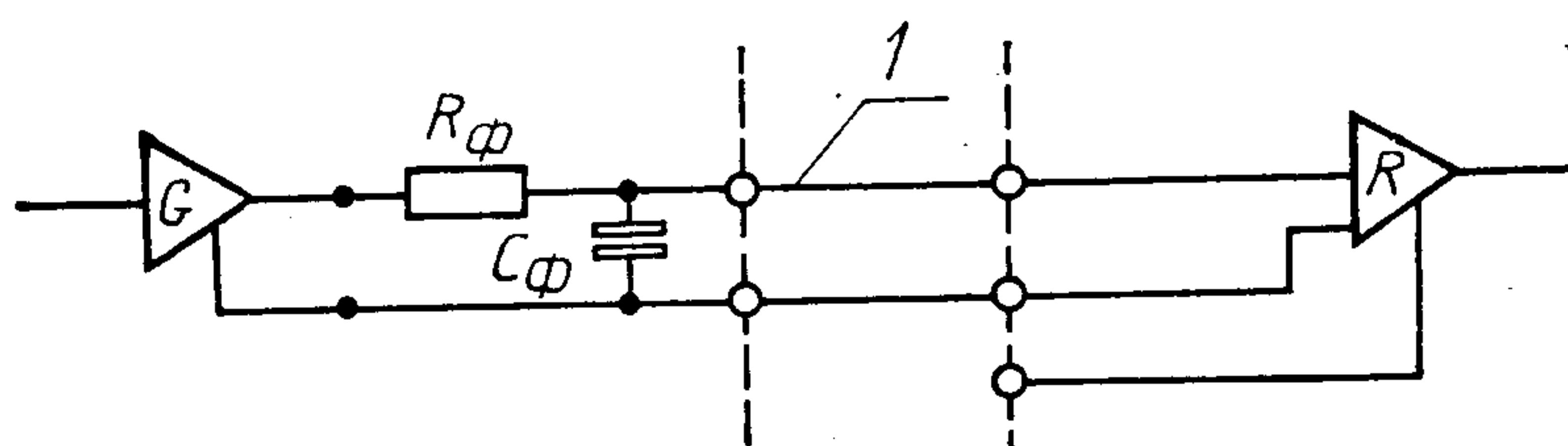
1—соединительный кабель;  $R_g$ —внутреннее сопротивление генератора;  $R_{\phi} = 50 \text{ Ом} - R_g$
