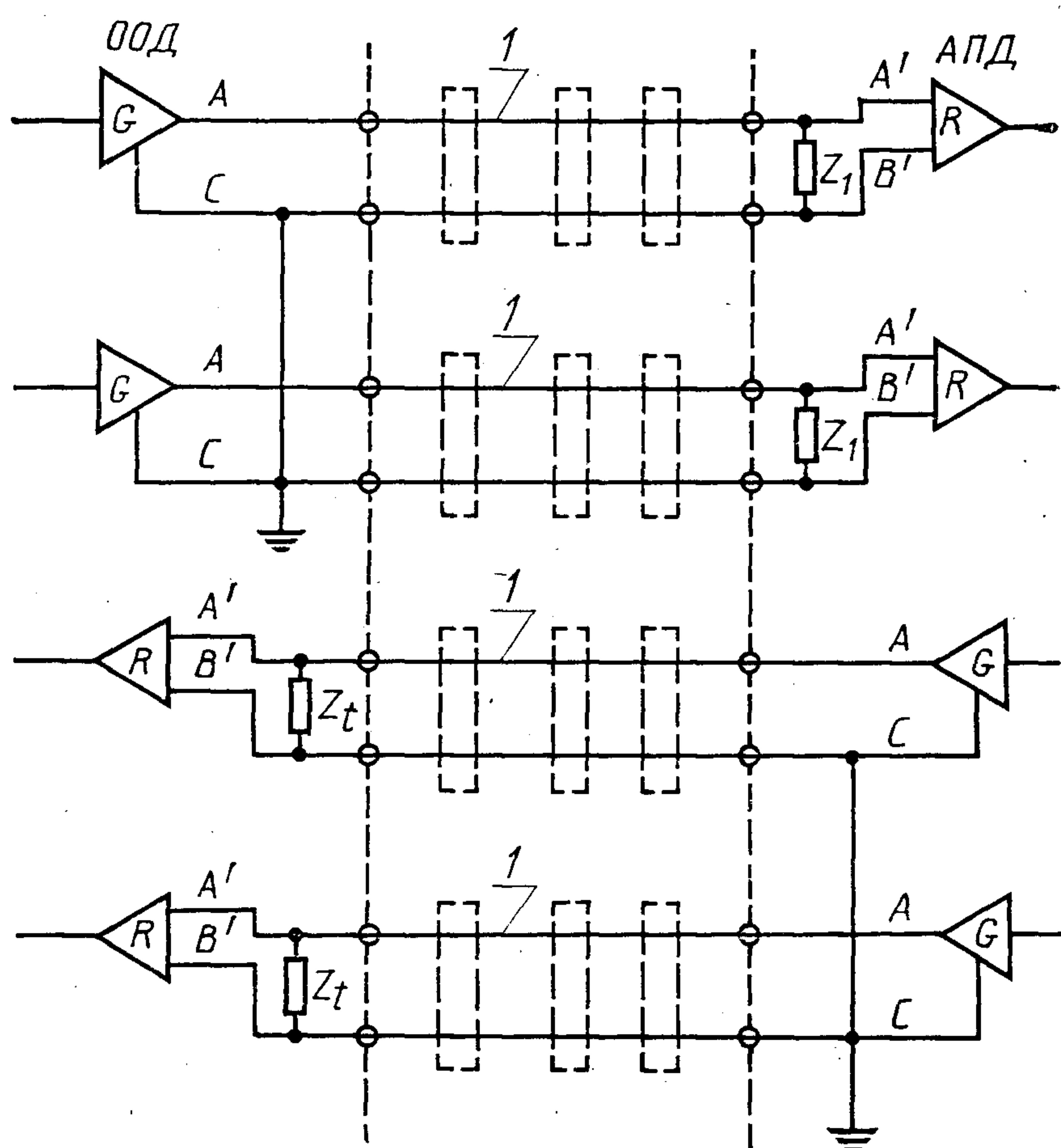
1—сигнальный провод;  $Z_1$ —согласующее сопротивление
