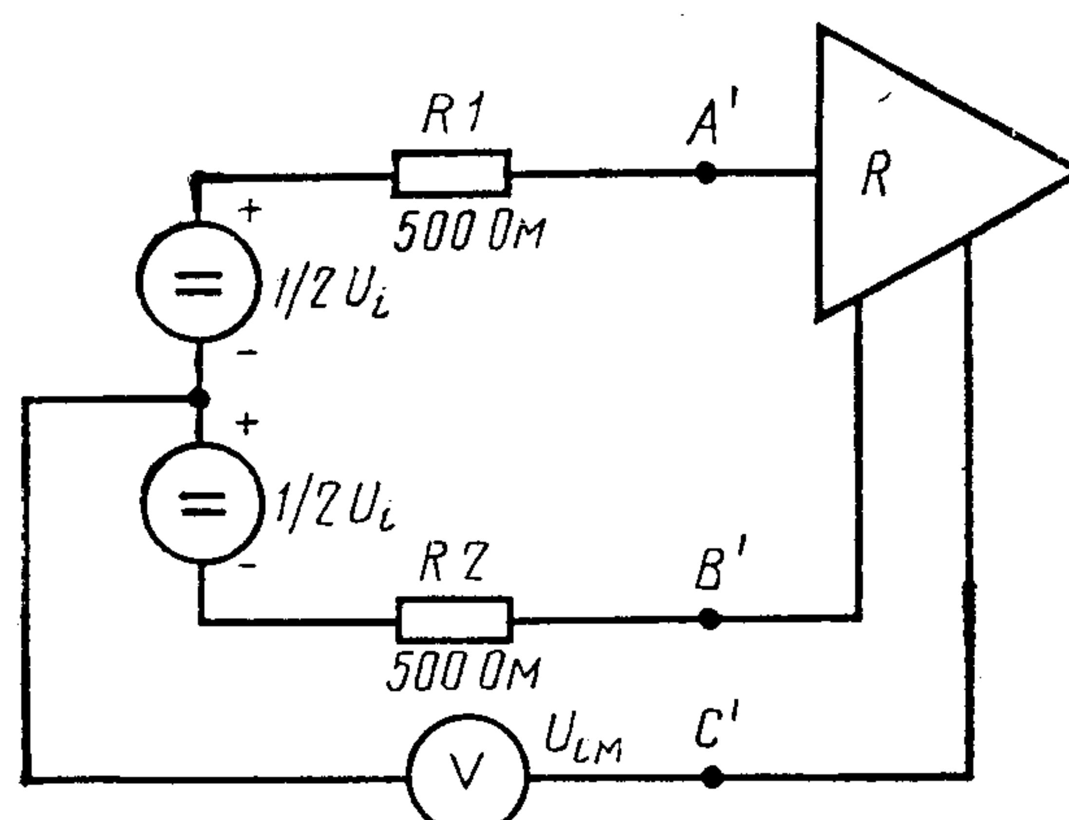
$U_i$  — испытательное напряжение;  $U_{iM}$  — напряжение смещения
