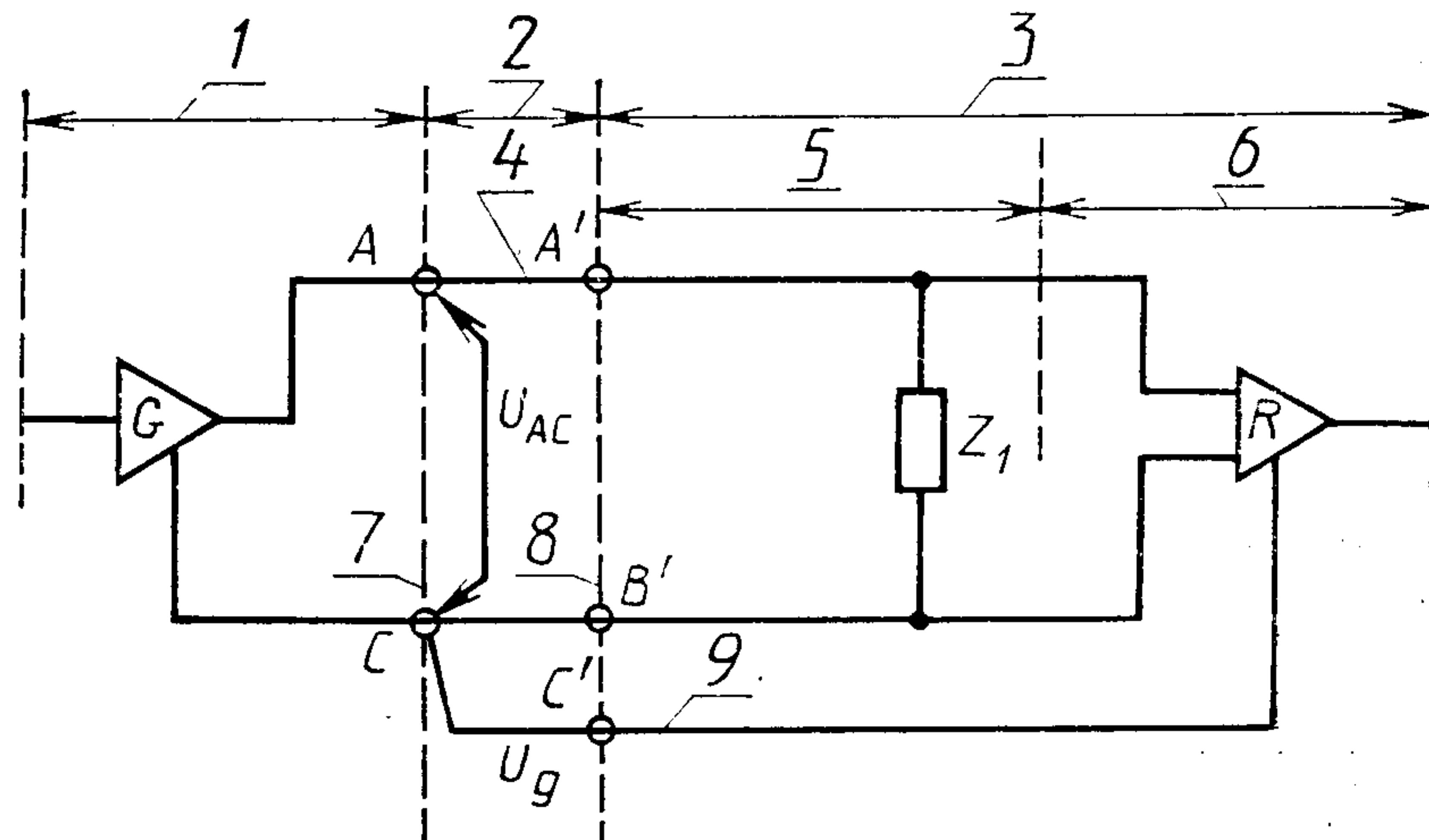
1—генератор; 2—соединительный кабель; 3—нагрузка; 4—сигнальный провод; 5—схема согласования; 6—приемник; 7—точка стыка генератора; 8—точка стыка нагрузки; 9—сигнальное заземление;  $U_{AC}$  — выходное напряжение генератора;  $U_g$  — разность потенциалов заземления;
