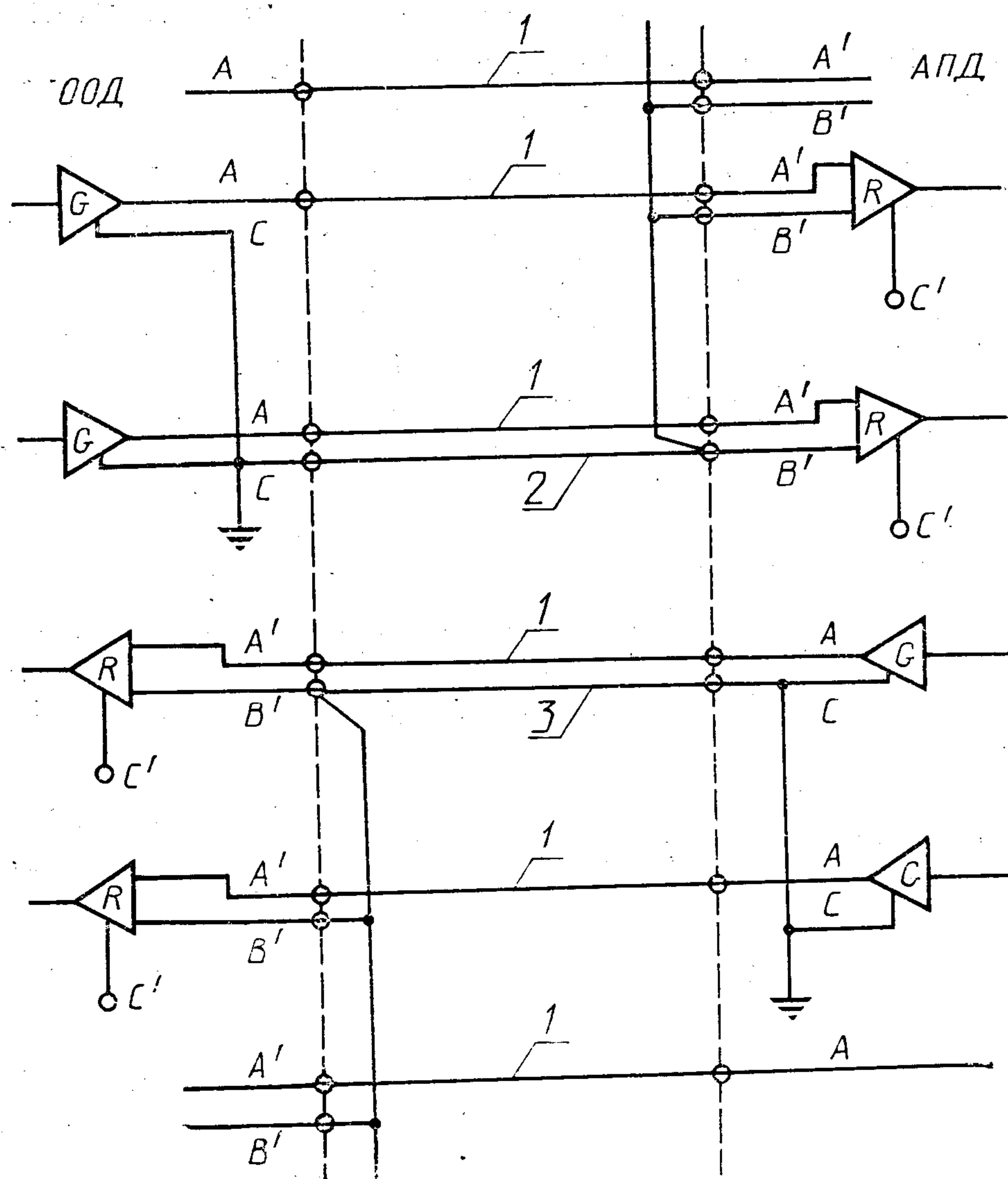
1—сигнальный провод; 2—обратный провод ООД (цепь 102 а);
