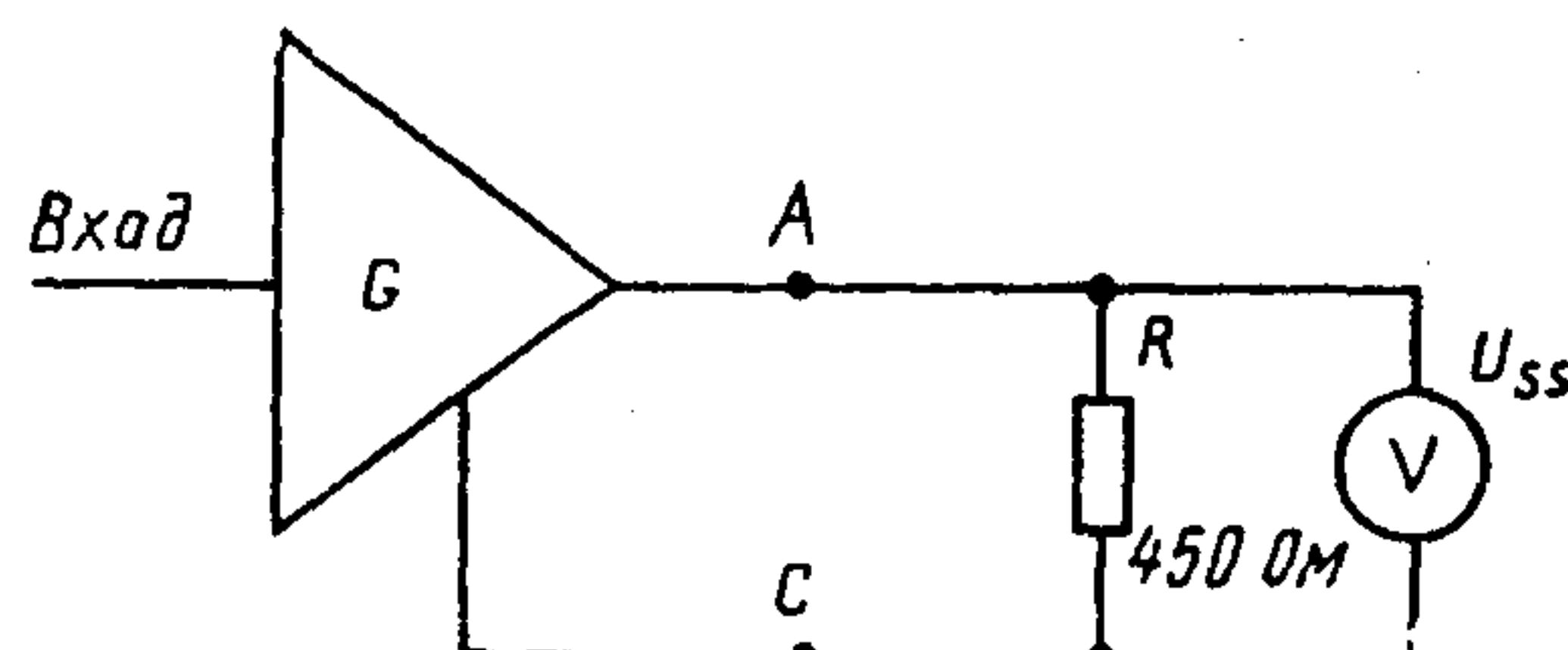
$U_{ss}$  — разность напряжений устойчивых состояний генератора
